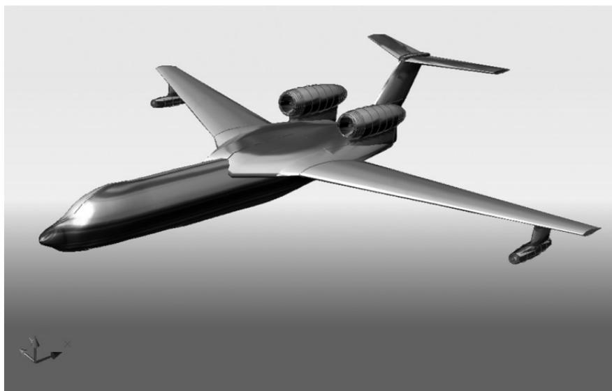
Рис. 7.30. Твёрдотельная тонированная модель самолета-амфибии
