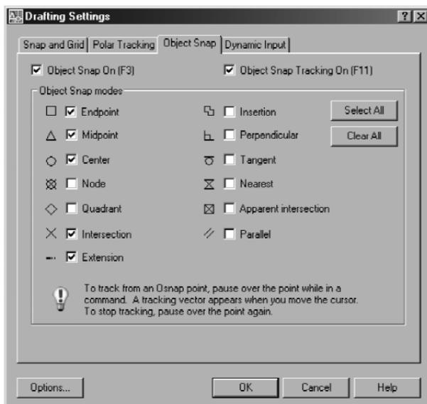
Рис. 1.13. Диалоговое окно **Drafting Settings** (Параметры привязки), закладка **Object Snap** (Объектная привязка)
