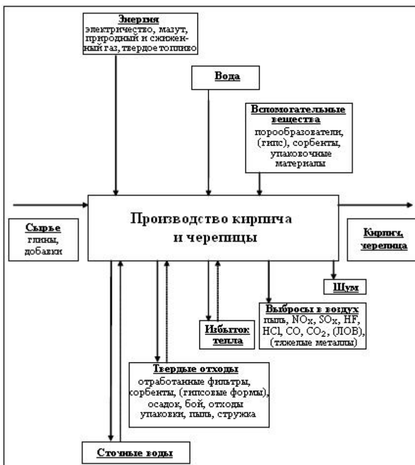
РИС. 2.13. ВХОДНЫЕ И ВЫХОДНЫЕ ПОТОКИ В ПРОИЗВОДСТВЕ КИРПИЧА И ЧЕРЕПИЦЫ
