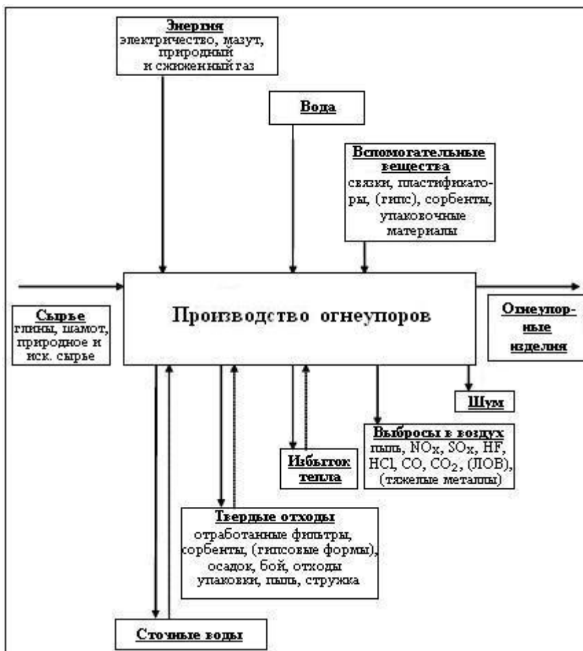
РИС. 2.17. ВХОДНЫЕ И ВЫХОДНЫЕ ПОТОКИ В ПРОИЗВОДСТВЕ ОГНЕУПОРНЫХ ИЗДЕЛИЙ
