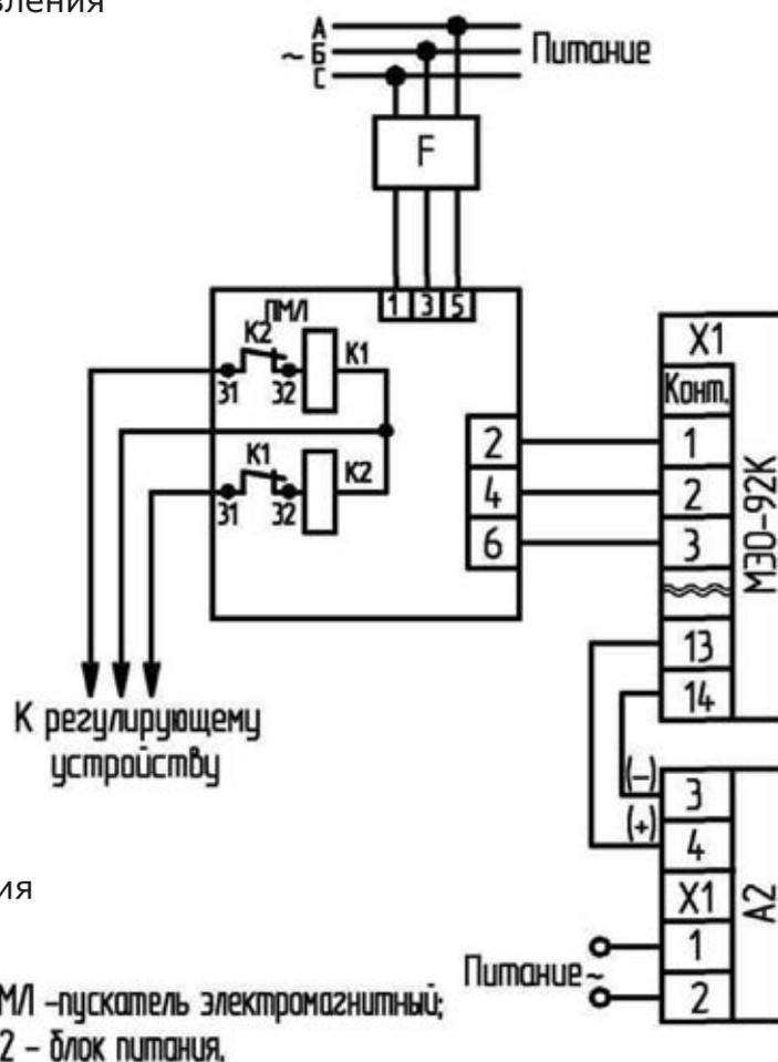
Рисунок В.2- Схема контактного управления
