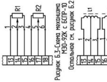
Рисунок Б.3-Схема механизма МЭО-92К с БСПР-10
