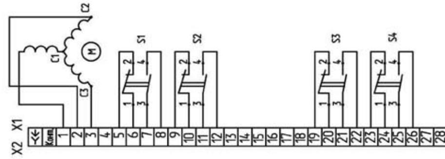
Рисунок Б.2-Схема механизма МЭО-92К с БКВ;
