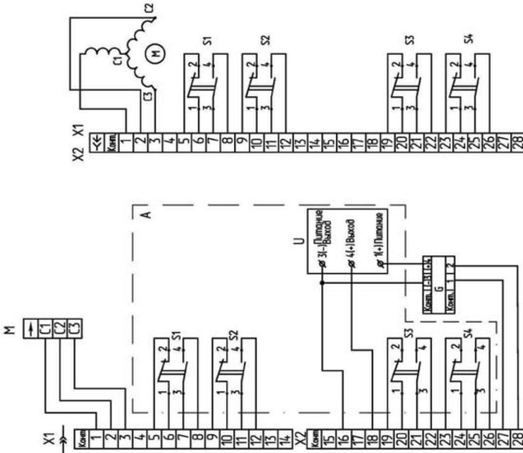
Рисунок Б.1-Схема механизма МЭО-92КБ
