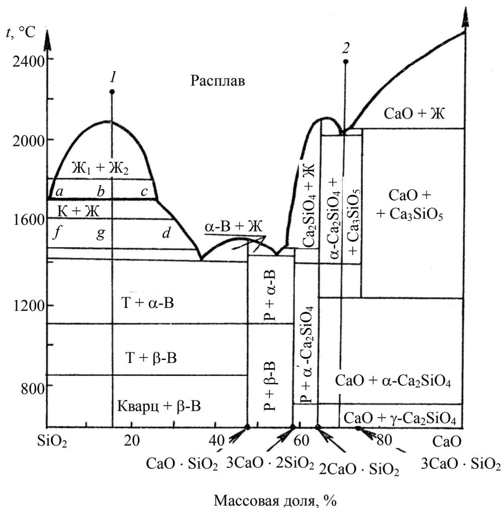
Рис. 2.1. Диаграмма состояния системы  $\text{CaO} - \text{SiO}_2$
