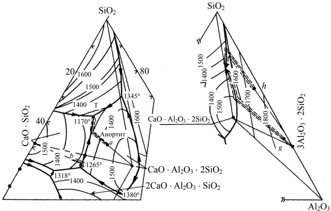
Рис. 2.2. Диаграмма состояния системы  $\text{CaO} - \text{Al}_2\text{O}_3 - \text{SiO}_2$
