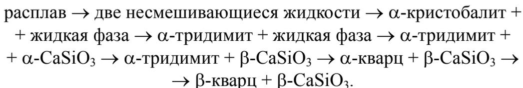
**Пример 2.1.3.** Найти соотношение между фазами, образовавшимися при охлаждении расплава состава 15% CaO и 85% SiO<sub>2</sub> до температур 1800, 1600°C и при полной кристаллизации.
