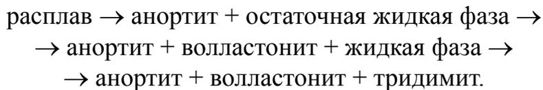
Путь кристаллизации состава  $b$  пройдет из точки состава волластонита (первичная кристаллическая фаза) через точку  $b$  в сторону пограничной кривой между  $\text{CaO} \cdot \text{SiO}_2$  и  $\text{CaO} \cdot \text{Al}_2\text{O}_3 \cdot 2\text{SiO}_2$ . На пограничной кривой выделяется вторая кристаллическая фаза – анортит. Далее путь кристаллизации проследует вниз по пограничной
