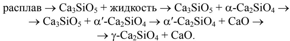
**Пример 2.1.2.** Показать схему фазовых превращений при охлаждении для смеси 15% CaO и 85% SiO<sub>2</sub> (точка 1 на рис. 2.1).
