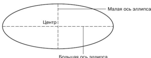
**Рис. 2.21.** Параметры, используемые при построении эллипса
